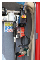
Linia napełniająca z wlewem 2" oraz suchozłazcem VK50 - wewnątrz szafy dystrybucyjnej
