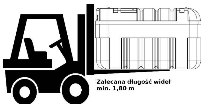
Rysunek 1. Schemat podnoszenia zbiornika za pomocą wózka widłowego. Min. zalecana długość widel 1,8 m.
